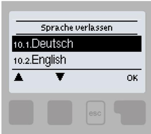
Zur Wahl der Menüsprache. Bei der ersten Inbetriebnahme und bei längerer Spannungsunterbrechung erfolgt die Abfrage automatisch. Die wählbaren Sprachen können sich je nach Geräteausführung unterscheiden! Die Sprachwahl ist nicht in jeder Geräteausführung vorhanden!
