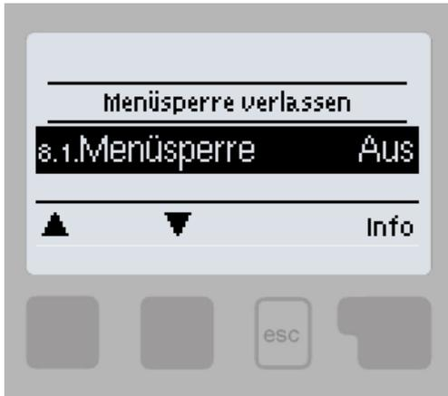
Durch aktivierte Menüsperre können die eingestellten Werte gegen unbeabsichtigtes Verstellen gesichert werden.
