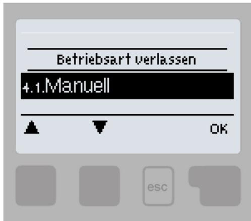
Zur Festlegung der Betriebsarten für den Heizkreisbetrieb. Nach einer Netzspannungsunterbrechung kehrt der Regler selbstständig in die zuletzt gewählte Betriebsart zurück!
